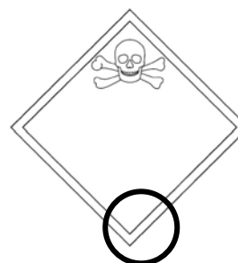
Placa de Riesgo Secundario
